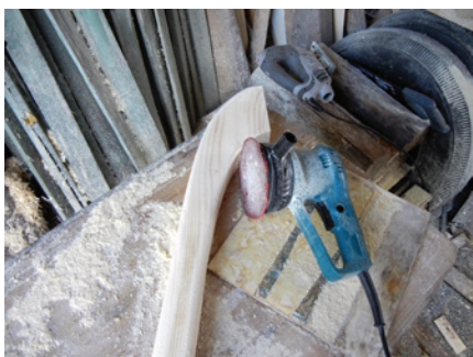
Поверхности поручня выровняли шлифовальной машинкой.
