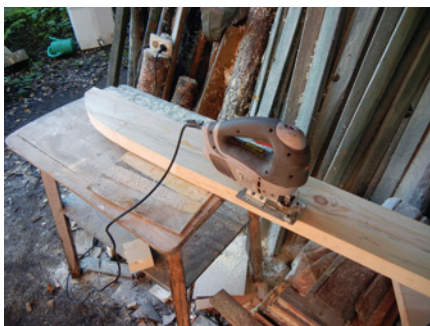
Поручень довольно сложной формы выкроили из сухой доски.
