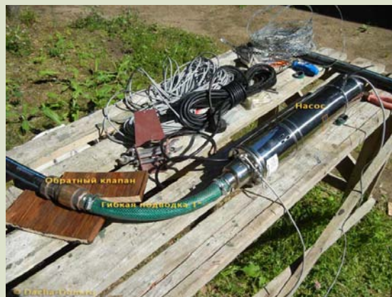
Фотографии №2 и №3. Подключение погружного насоса к трубопроводу через гибкий шланг.
