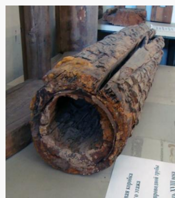
Деревянная водопроводная труба. Дворец А.Д. Меншикова. Санкт-Петербург. Первая половина XVIII века. Фотография автора.
