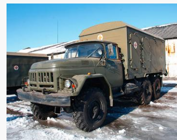
Установка дезинфекционно-душевая ДДА-3 на шасси автомобиля ЗИЛ -131, обеспечивающая полевую баню горячей водой и паром. Фотография: Андрей Артюховский. «Белорусская военная газета» № 63 от 04 апреля 2013 года.
